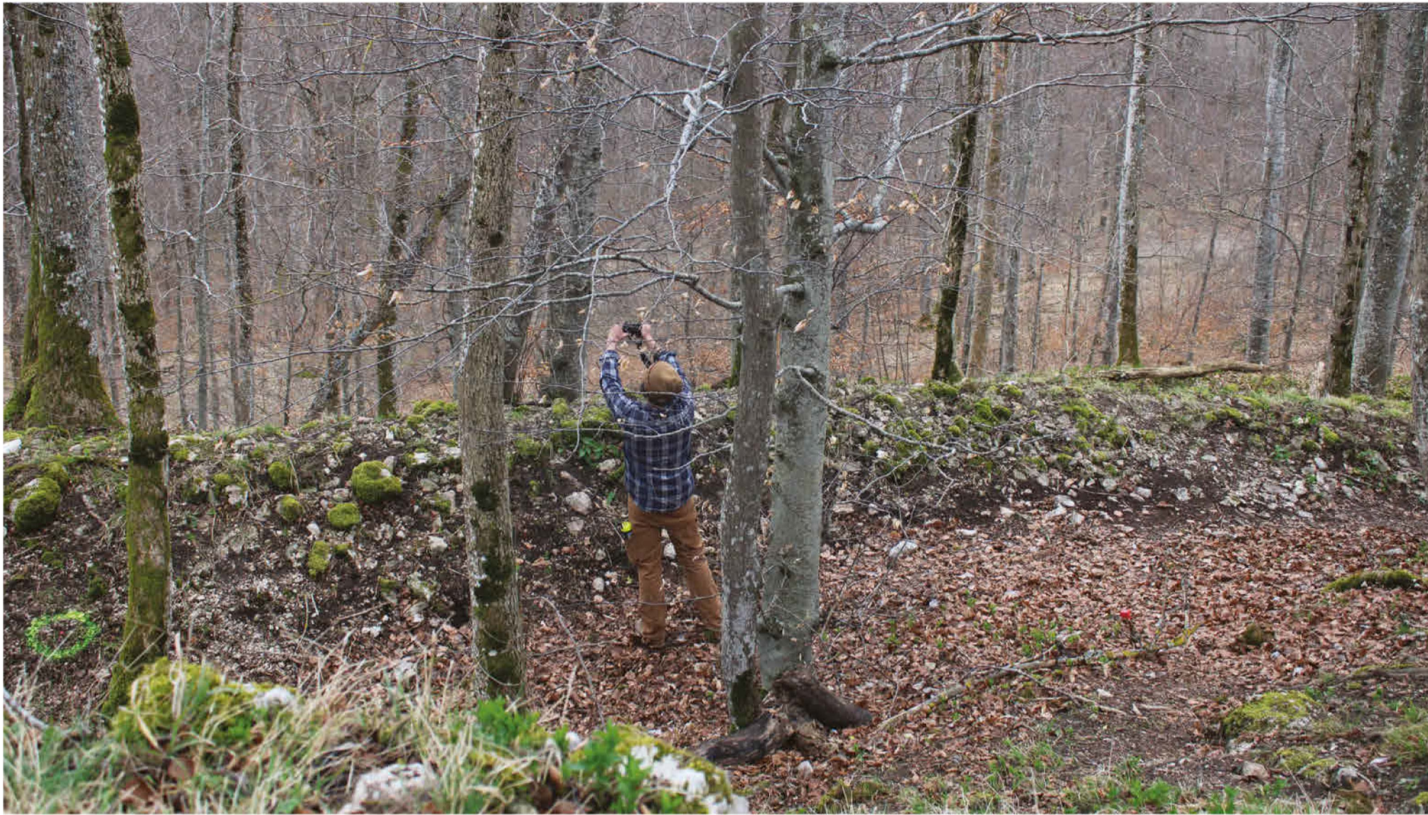
Von jedem Objekt werden zahlreiche Fotos möglichst senkrecht aufgenommen, die sich immer deutlich überlappen.
